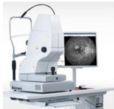
Рис.1. Цифровая фундус-камера для флюоресцентной ангиографии
